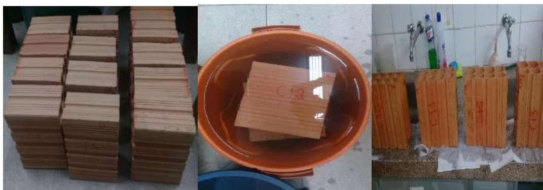
Figura 2. A) blocos após determinação da M_s . B) blocos imersos em água. C) blocos saturados para pesagem.
